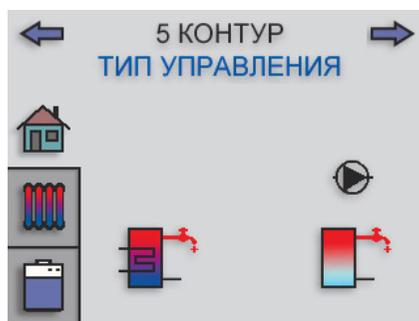
11. **Конфигурация 5 контура отопления.** Можно выбрать: насос, бойлер или линию рециркуляции ГВС. По умолчанию ничего не выбрано.
