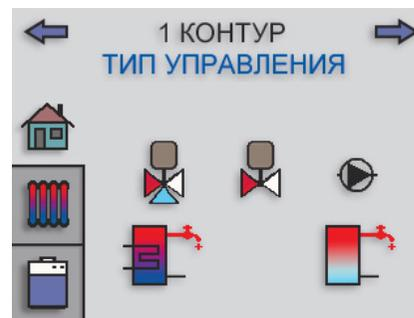
10. **Конфигурация контуров отопления с 1 по 4.** Можно выбрать: только клапан, клапан и насос, только насос, бойлер или линию рециркуляции ГВС. В блоке возможен только 1 бойлер и одна линия рециркуляции ГВС. По умолчанию ничего не выбрано.
