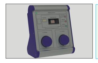
Разработка рабочей документации и эл.схемы термостатного пульта управления для газового котла с двухступенчатой горелкой.
