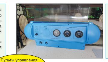
Пульт изготовлен, протестирован на реальной котельной и запущен в производство.
