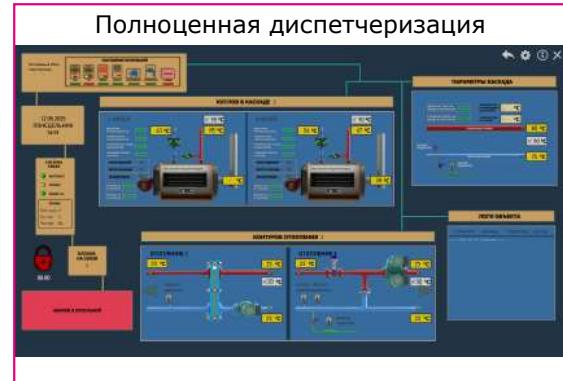
Блок Wi-Fi диспетчеризации "УКонт-14" обеспечивает передачу текущих и аварийных данных на сервер в режиме реального времени
