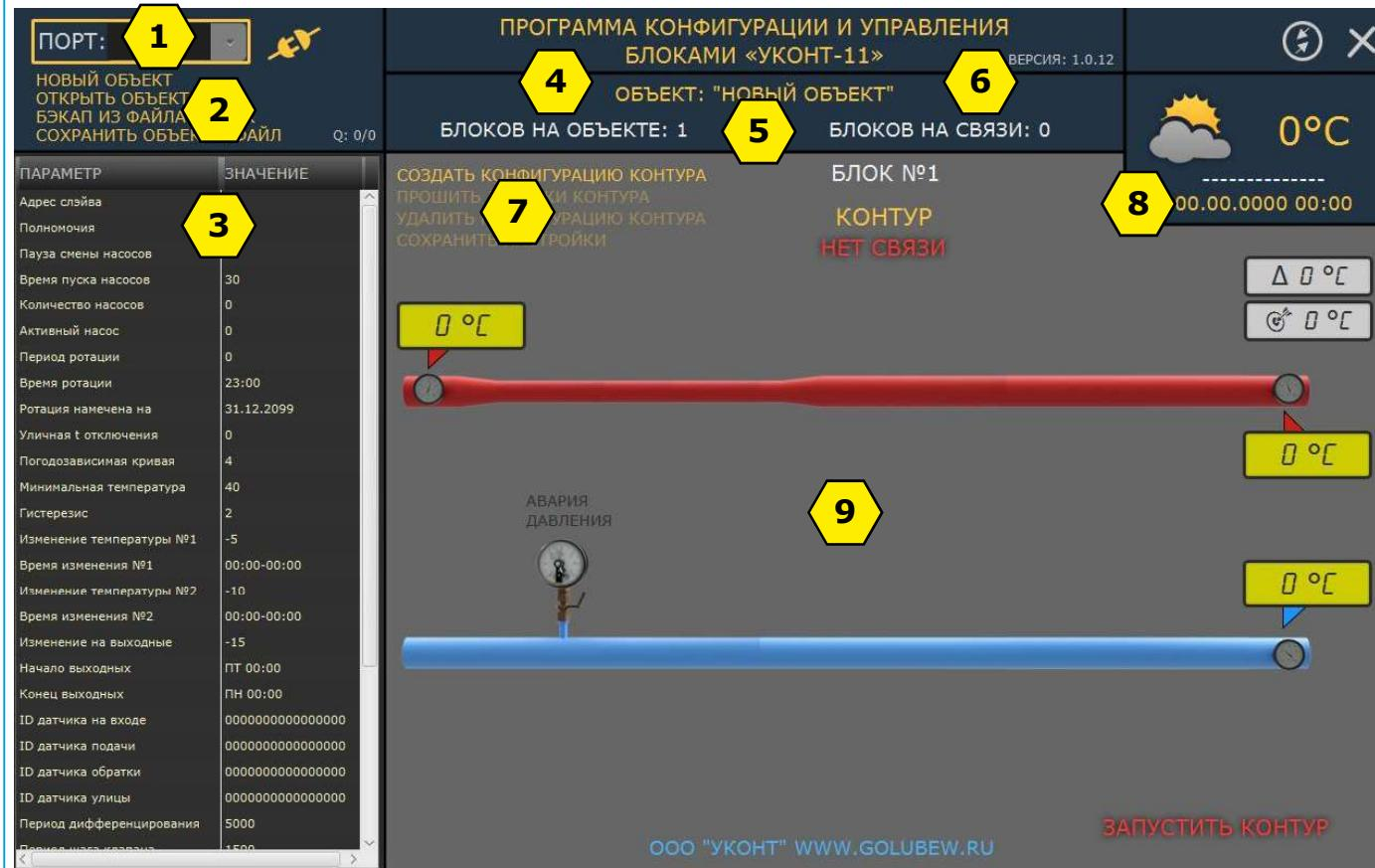
Поз.1: подключение блока к программе конфигурации.
