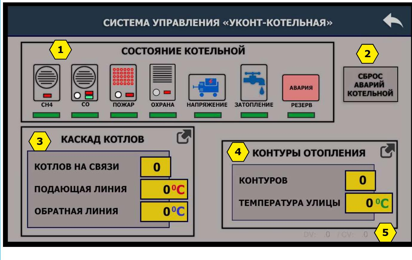
Поз.1: панель состояния датчиков безопасности, подключенных к блоку "УКонт-14".
