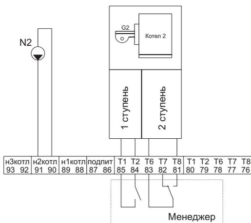
Рис. 2.3. Схема подключения котла №2 и насоса №2
