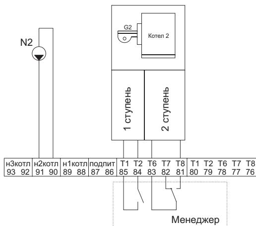
Рис. 2.3. Схема подключения котла №2 и насоса №2
