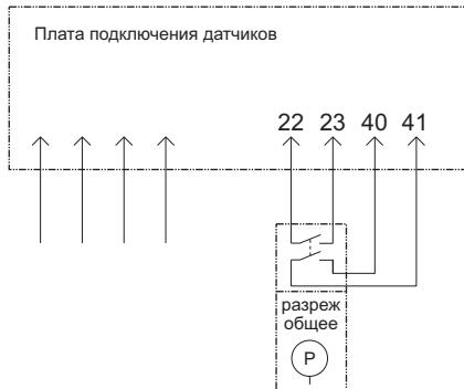
Рис. 2.8. Схема подключения датчика отсутствия разрежения дымохода
