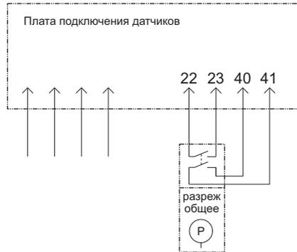
Рис. 2.8. Схема подключения датчика отсутствия разрежения дымохода
