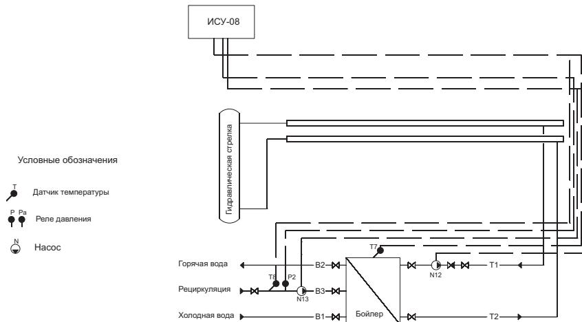
Рис. 2.4. Схема контура ГВС и рециркуляции ГВС
