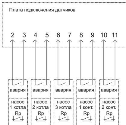
Рис. 2.7. Схема подключения некоторых датчиков технологической сигнализации
