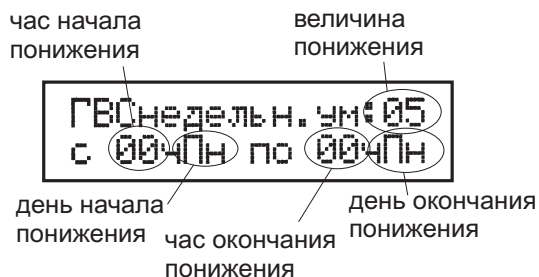
Рис.3.4. Настройка недельного понижения для ГВС
